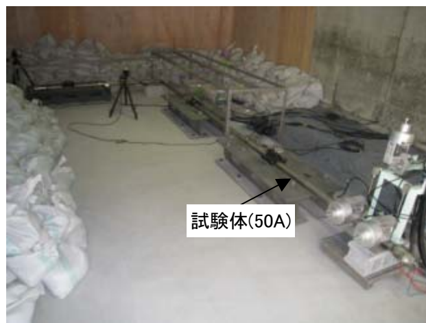
付録図 6.2-2 爆轟試験体設置状況
